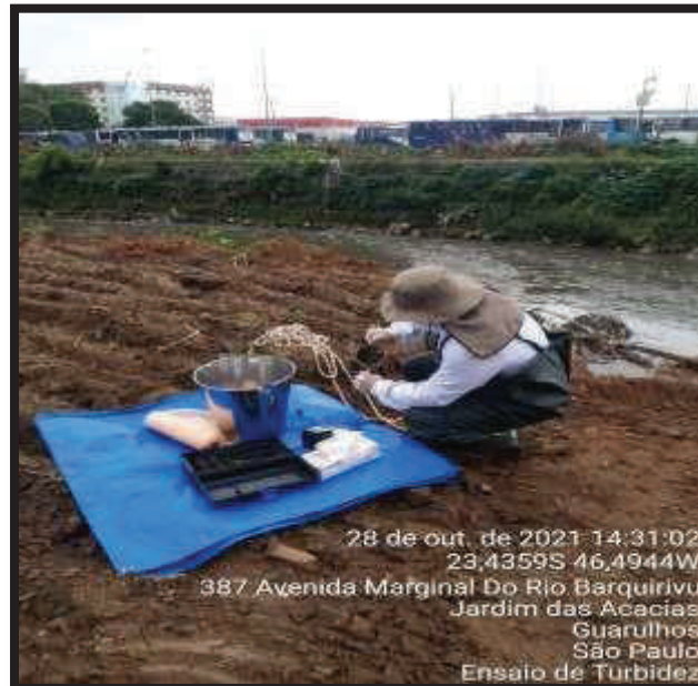
Foto 1 - Procedimento de monitoramento e medição de campo do parâmetro Turbidez – Ponto 01.
