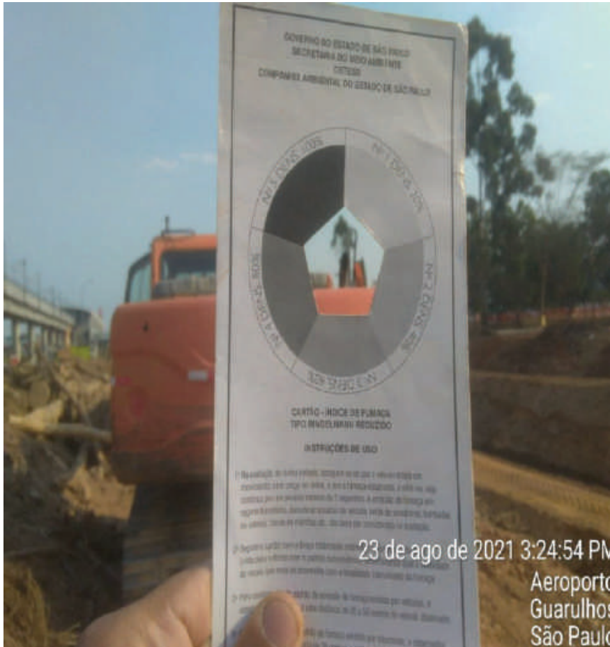
FOTO 11- MEDIÇÃO COM ESCALA RINGELMANN – 23/08/2021
