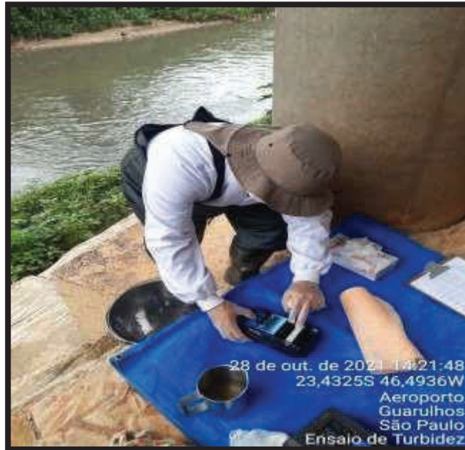
Foto 1 - Procedimento de monitoramento e medição de campo do parâmetro Turbidez – Ponto 01.
