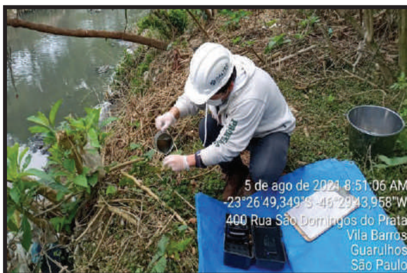
Foto 4 - Procedimento de monitoramento e medição de campo do parâmetro Turbidez – Ponto 04.
