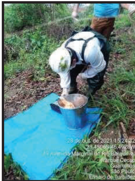
Foto 5 - Procedimento de monitoramento e medição de campo do parâmetro Turbidez – Ponto 05.
