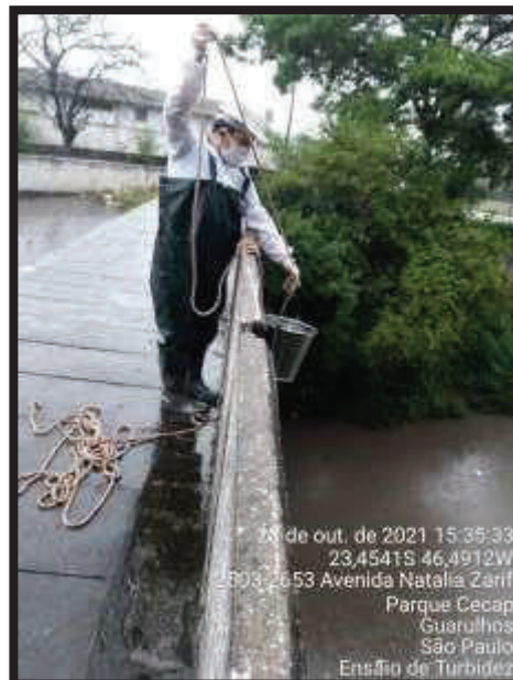
Foto 6 - Procedimento de monitoramento e medição de campo do parâmetro Turbidez – Ponto 06.
