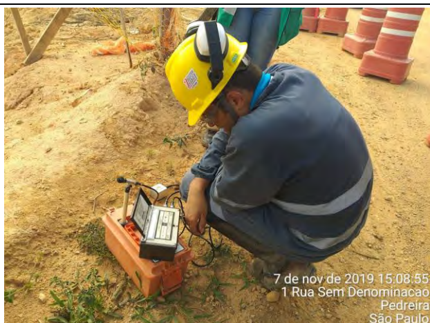
Foto 7 - Registro fotográfico do sismógrafo implantado no ponto da estrada próximo à Ensecadeira de Junsante,. (07/11/19)
