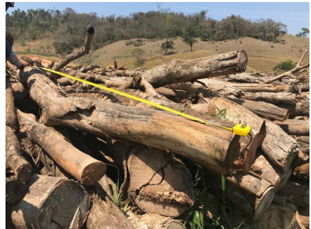
Foto 6 – Em detalhe o elevado grau de encurvamento encontrado em tora amostrada (setembro/2019).
