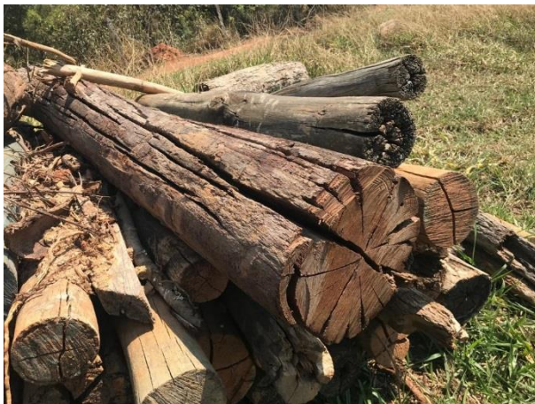
Foto 1 – As madeiras nativas estocadas apresentam rachaduras tangenciais e radiais (setembro/2019).
