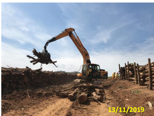
Foto 17 – Empilhamento mecanizado do material lenhoso.
