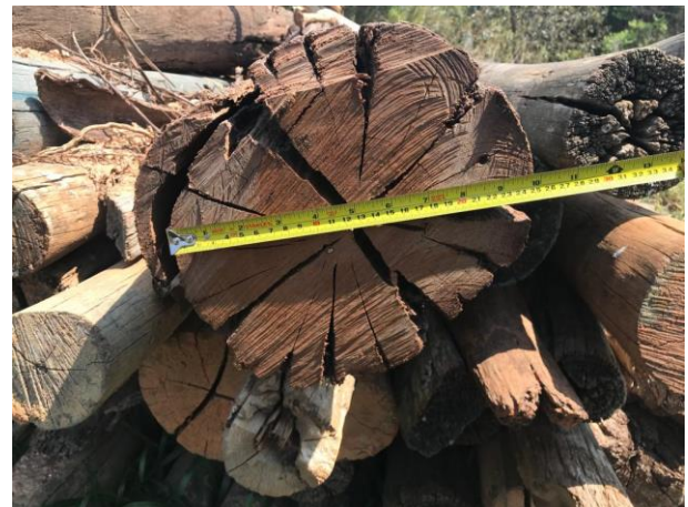
Foto 2 – Detalhe para madeira nativa com rachadura (setembro/2019).
