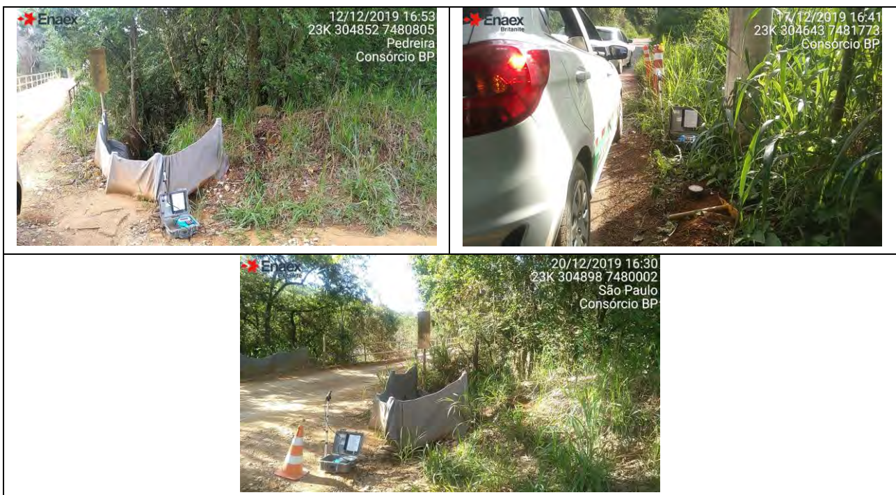
Figura 4. Local de monitoramento com sismógrafo instalado.
