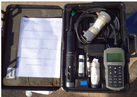
Fotos 3.2.1-1 e 3.2.1-2. Sonda Multiparâmetros Utilizada para Medições “in situ” e Armazenamento de Amostra de Água, Respectivamente.
