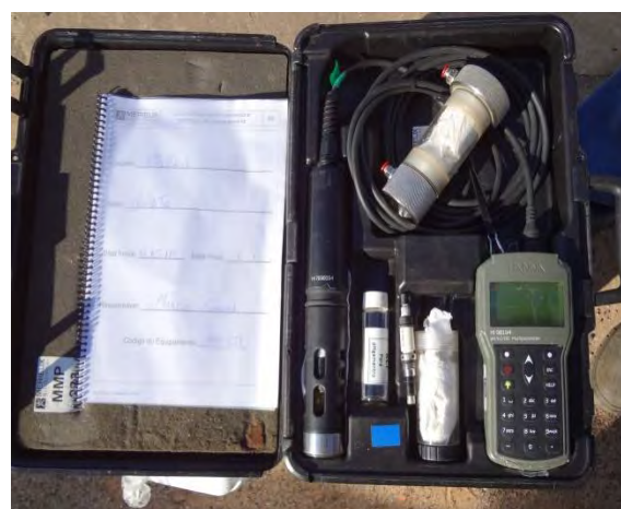
Foto 8 – Sonda Multiparâmetros Utilizada para Medições “in situ” (Foto: 04/10/2019)
