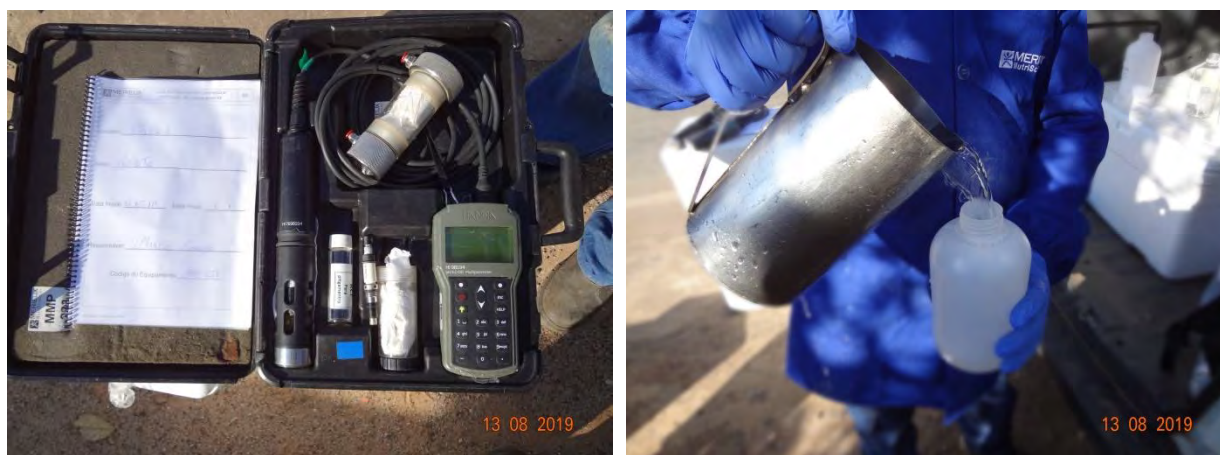
Fotos 3.2.1-1 e 3.2.1-2. Sonda multiparâmetros utilizada para medições “in situ” e armazenamento de amostra, respectivamente.
