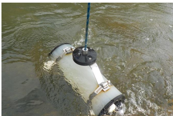
Foto 3.2.1-1. Garrafa de “Van Dorn” utilizada na amostragem quantitativa de fitoplâncton.
