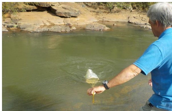
Fotos 3.2.2-1. Amostragem qualitativa do zooplâncton com rede de malha de 68 µm.
