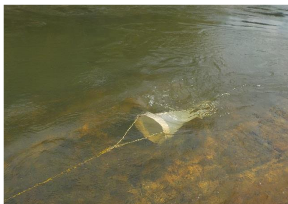
Foto 3.2.1-2. Amostragem qualitativa de fitoplâncton com arrasto horizontal.
