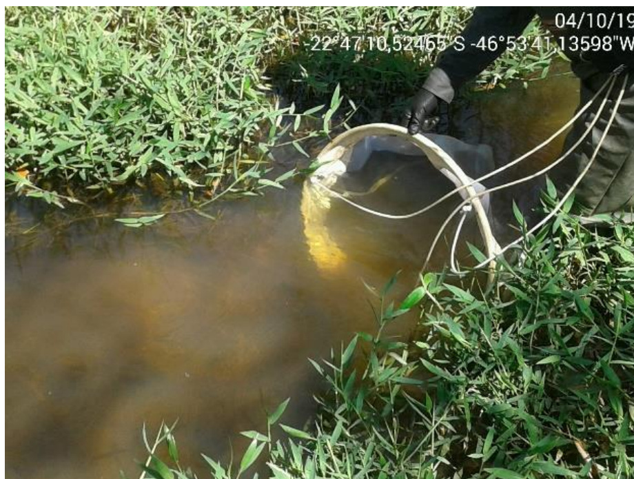
FOTO 2.3.2-1: Amostragem com rede de plâncton cônica.
