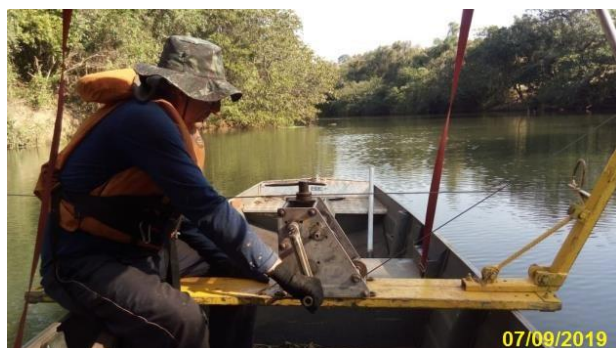
Foto 11 – Detalhe das atividades da medição de vazão no PHM – 1ª Campanha (Data: 07/09/19).
