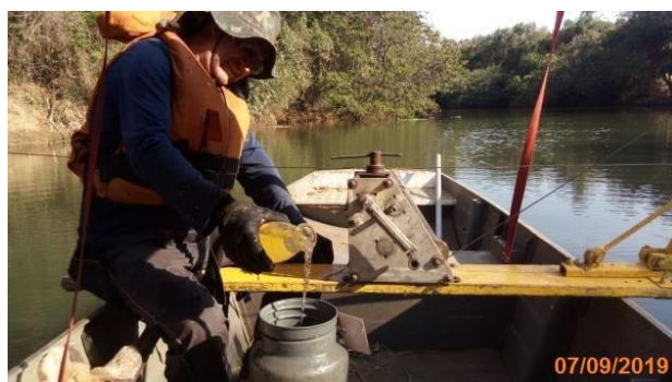
Foto 7 – Detalhe da coleta de amostra de sedimentos em suspensão no PHM -1°C (Data: 07/09/19)
