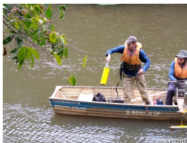
Foto 12 – Detalhe da coleta da amostragem de sedimentos no PHM – 3 a C. (Data: 25/11/19).
