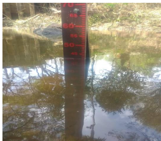
Foto 4 – Detalhe das réguas limnimétricas (05/09/2019)
