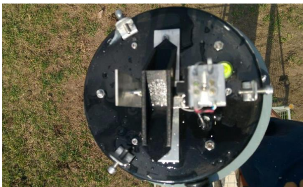
Foto 11 – Limpo Pluviômetro Aberto.
