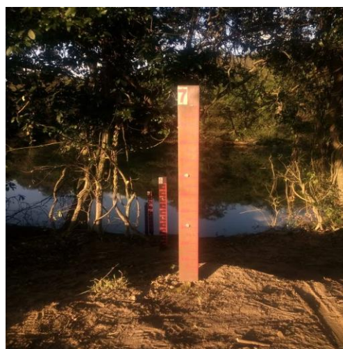
Foto 2 – Detalhe da seção de réguas limnimétricas (05/09/19).
