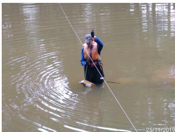
Foto 13 – Vista da coleta de sedimentos de leito no PHJ- 2 a C. (Data: 25/11/19).
