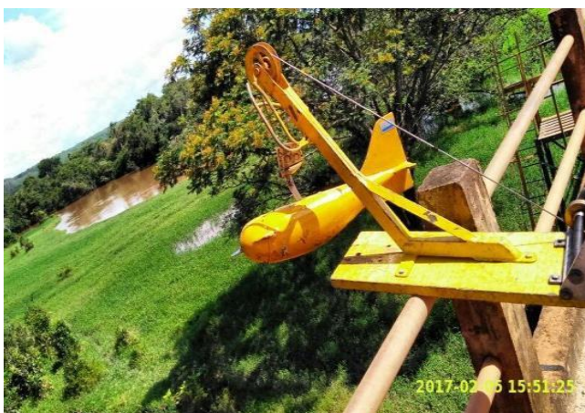
Foto 5 – Amostrador de Sedimento (Data: 10/19).
