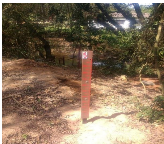
Foto 3 – Detalhe das réguas limnimétricas (05/09/2019)
