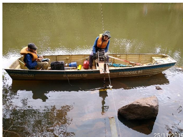
Foto 14 – Vista geral das atividades da medição de vazão no PHM – 3º Campanha (Data: 25/11/19).
