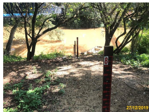
Foto 26 – Detalhe das réguas limnimétricas após a manutenção no PHJ -3°C (Data:27/12/19).
