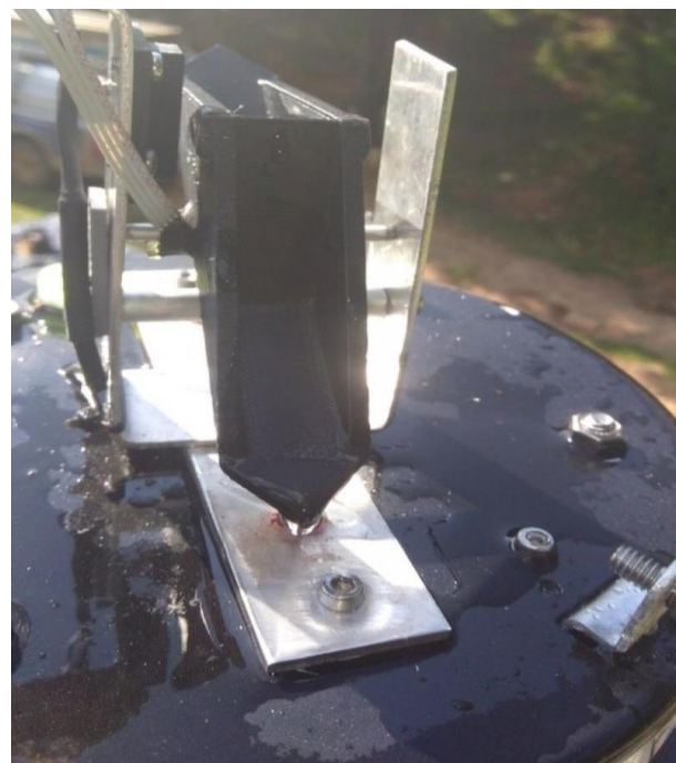
Foto 23 - Pluviômetro Aberto e Limpo
