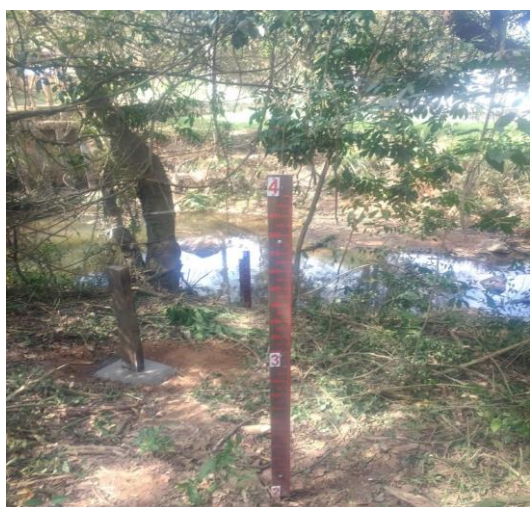
Foto 1 – Vista da seção de réguas limnimétricas (05/09/2019)
