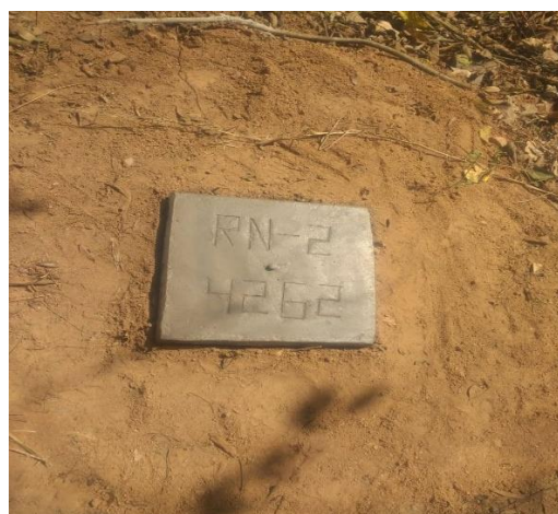
Foto 6 – Detalhe do marco de referência de nível (05/09/2019)
