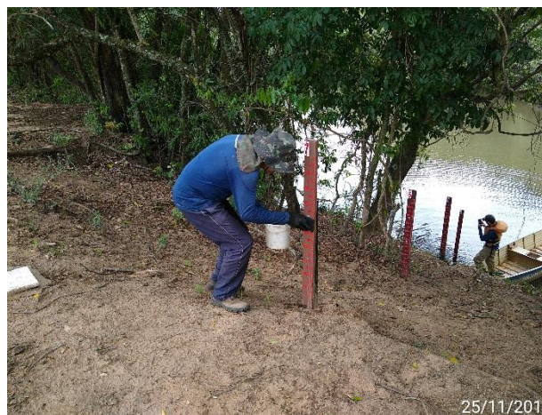
Foto 22 – Detalhe das atividades de limpeza das réguas limnimétricas no PHM-3°C (Data: 25/11/19)
