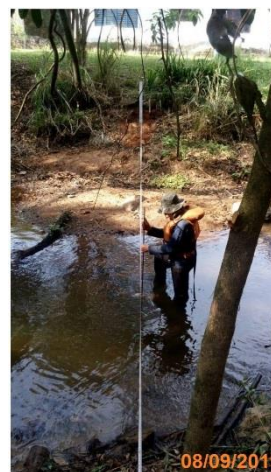
Foto 8 – Vista da campanha de descarga sólida no PSed -1°C (Data: 08/09/19)
