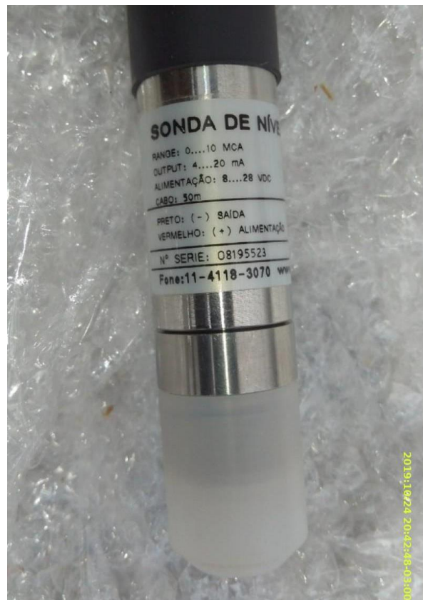
Foto 45 – Especificação técnica da sonda.
