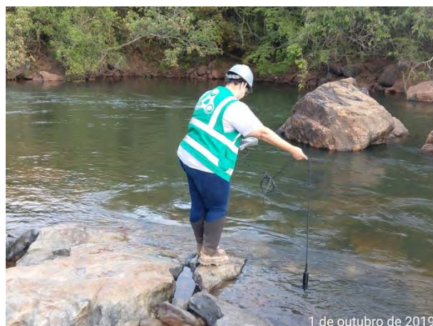
Foto 341 —Monitoramento de multiparâmetros da água. (Data:01/10/19)
