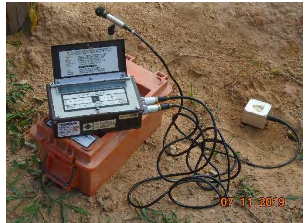
Foto 98 —Sismógrafo para registro de vibração e pressão acústica. (Data:07/11/19)
