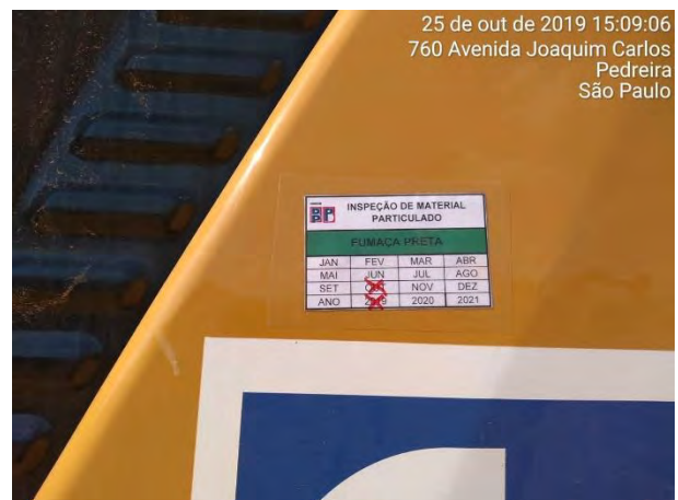
Foto 274 – Adesivo fixado nos equipamentos que são monitorados. (Data:25/10/19)
