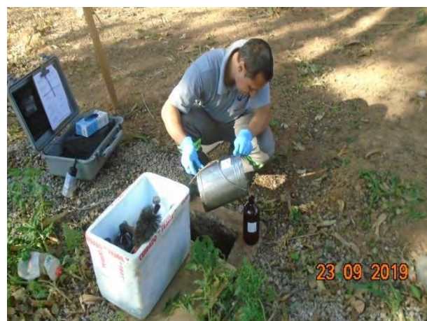
Foto 256 —Coleta de amostra de efluente do biodigestor instalado no canteiro administrativo.
