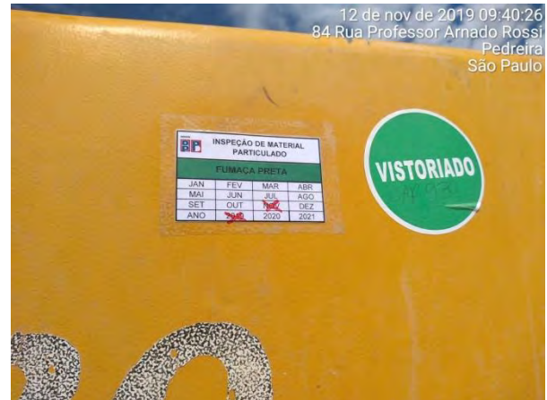
Foto 276 —Adesivo fixado nos equipamentos que são monitorados. (Data:12/11/19)
