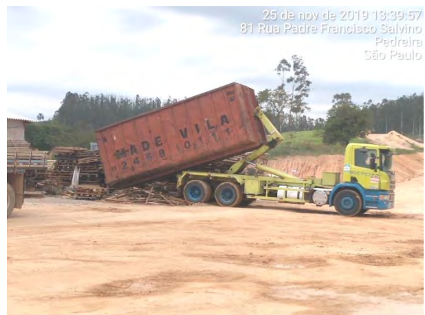
Foto 296 – Troca de caçamba de resíduos de madeira. (Data:25/11/19)
