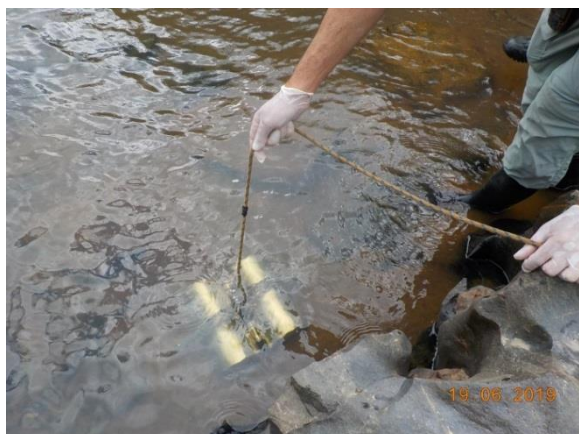
Foto 8 - Coleta de sedimentos para análises de invertebrados bentônicos com Petersen , durante a coleta para a última campanha em junho/2019.
