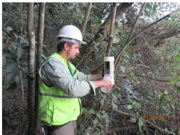
Foto 1 - Instalação da armadilha do tipo CDC.
