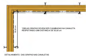
DETALHAMENTO DAS GRAPAS NAS CANALETAS Esc: 1/10
