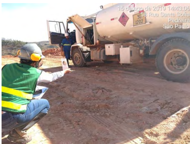
Foto 170 - Monitoramento de fumaça preta em equipamento do empreendimento.
