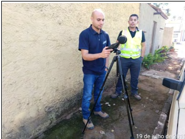
Foto 173 - Avaliação de ruído ambiental sendo realizada por profissional habilitado, ponto 1.
