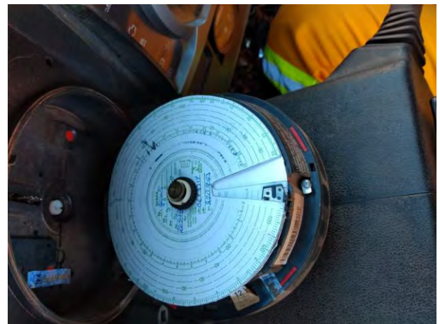
Foto 57- Inspeção de tacógrafo dos ônibus. (Foto: 28.05.2019)
