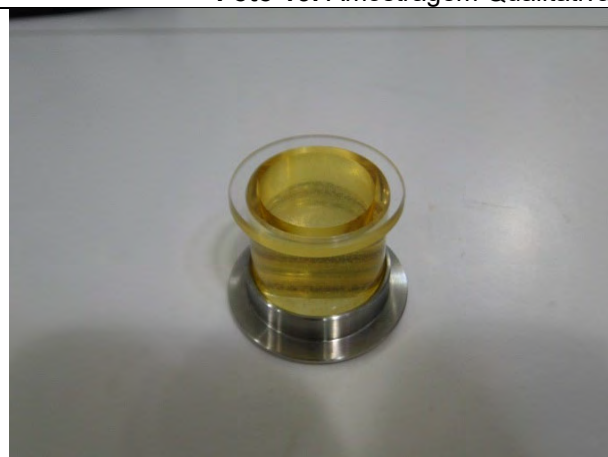
Foto 16: Amostra na Câmara de Sedimentação de Utermöhl e Contagem do Fitoplâncton em Microscópio Invertido.
