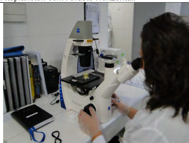
Foto 17: Amostra na Câmara de Sedimentação de Utermöhl e Contagem do Fitoplâncton em Microscópio Invertido.
