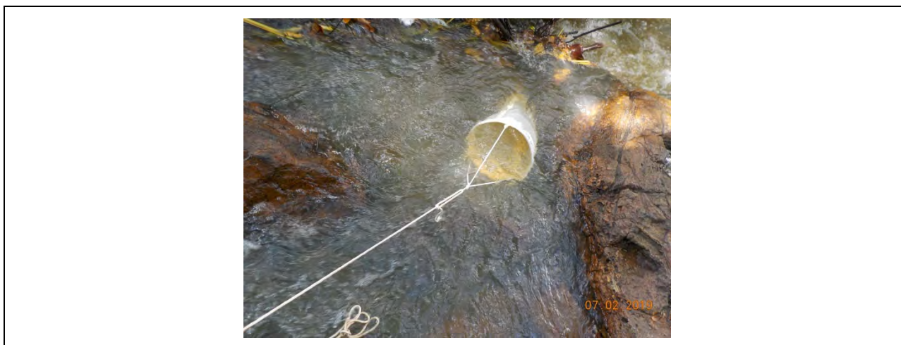
Foto 20: Amostragem Qualitativa do Zooplâncton com Rede de Malha de 68 µm
