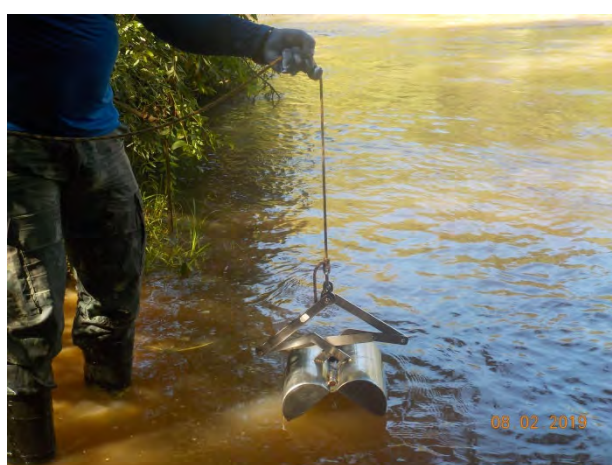
Foto 25: Coleta de Sedimentos para Análises de Invertebrados Bentônicos com Petersen e Lavagem de Sedimento em campo
