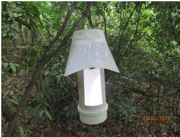
Foto 2.1.2-1: Armadilha CDC instalada
