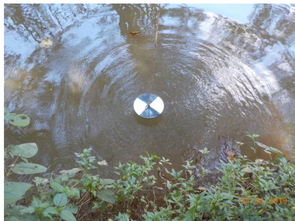
**Foto 7 e 8:** Medição de parâmetros físico-químicos com sonda multiparâmetros e uso de disco de Secchi para medir a transparência.
