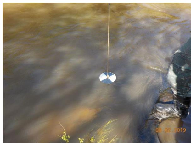
**Foto 9 e 10:** Medição de parâmetros físico-químicos com sonda multiparâmetro e uso de disco de Secchi para medir a transparência.
