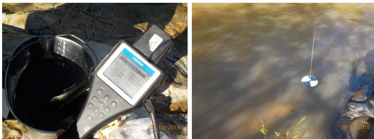
**Fotos 3.2.1-1 e 3.2.1-2. Medição in Situ com Sonda Multiparâmetros e Aferição da
