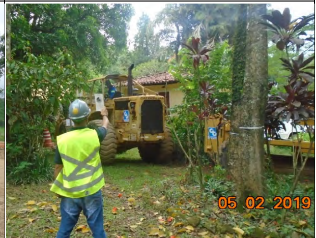
Foto 142 – Monitoramento de fumaça preta utilizando a escala Ringelmann. (Foto: 05 02 2019)
