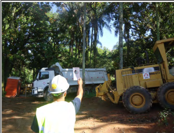
Foto 139 - Monitoramento de fumaça pretautilizando a escala Ringelmann. (Foto:07.01.2019)
