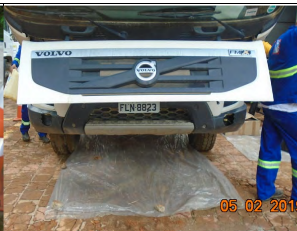
Foto 22 – Colaborador instalando itens (lona e bandeja) de proteção antes de iniciar manutenção.
