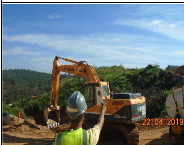
Foto 147 – Monitoramento de fumaça preta utilizando a escala Ringelmann.
