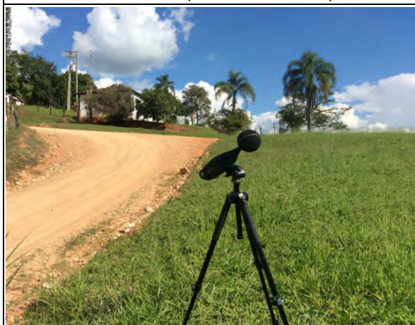
Foto 151 - Avaliação de ruído ambiental no ponto 3, sendo realizada por profissional qualificado da Geotec. (Foto:24/04/2019)
