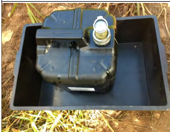
Foto 25 – Produto químico em utilização com a devida bandeja de contenção (Foto:23.04.2019).
