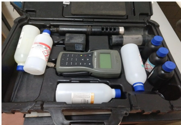
Foto 35. Sonda multiparâmetros (Foto: 28/03/2019)
