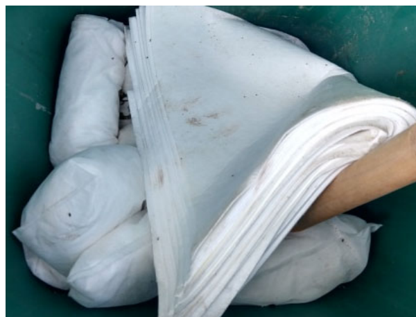
Foto 38. Kit de emergência ambiental disponível nas frentes de serviço. (Foto: 28/03/2019)
