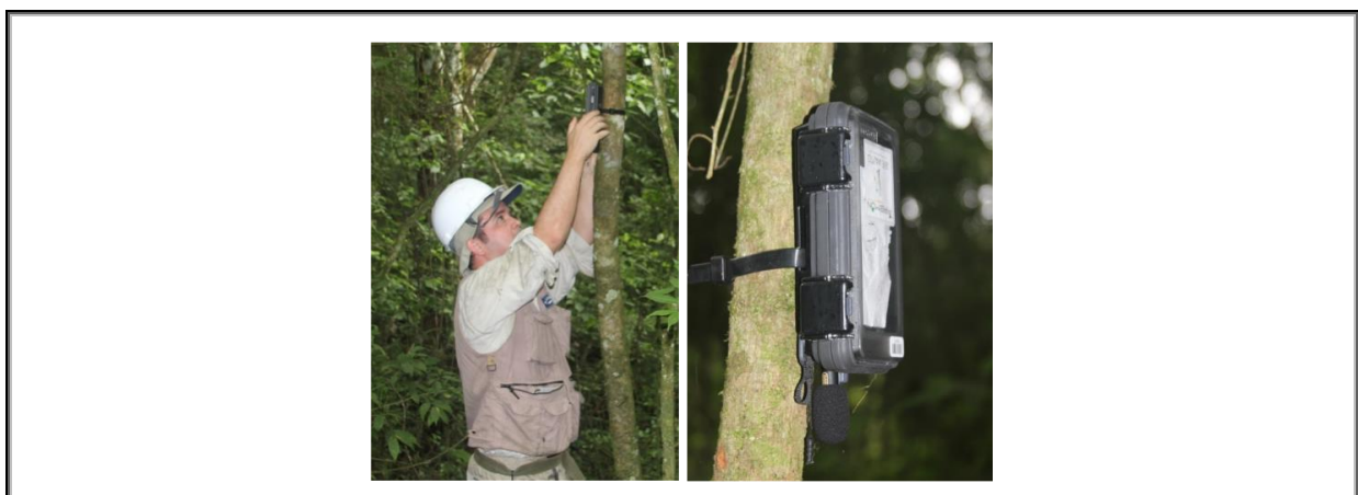
Foto 5.1.3.2-2 – Exemplo de equipamento instalado em campo para o monitoramento acústico passivo.
