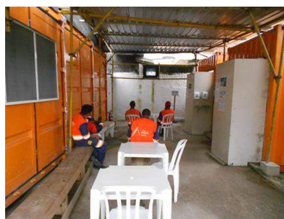
Fotos 7.1.3-1 e 7.1.3-2 – Exemplo de instalações adequadas para refeitórios instalados dentro de canteiros de obra.
