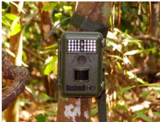
Foto 5.1.3.2-1 – Exemplo de equipamento instalado em campo para obtenção automática de registros fotográficos de espécimes animais de médio e grande porte - Armadilha fotográfica modelo Bushnell HD.
