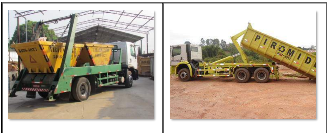
Fotos 5.4-1 e 5.4-2 – Exemplos de caminhão poliguindaste e caminhão-caçamba para retirada e transportes de resíduos gerados nas atividades construtivas.
